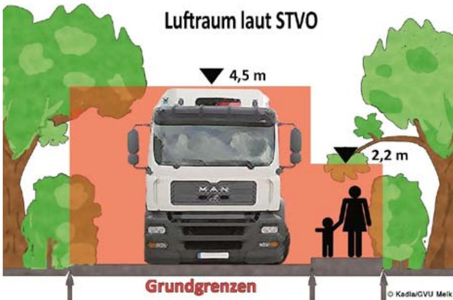
der Luftraum oberhalb der Straße bis mind. 4,50 m und über dem Gehsteig mindestens 2,20 m in der Höhe freigehalten werden muss. Beleuchtungsanlagen sind so auszuschneiden, dass die Beleuchtung der Straße bzw. des Weges und Gehsteiges nicht eingeschränkt.
